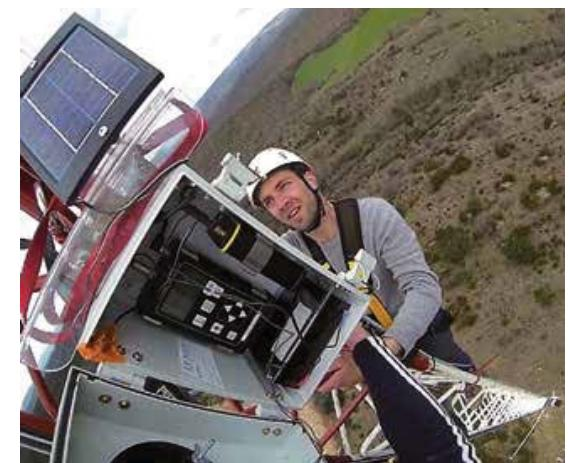
Système de détection automatique installé sur un mât de mesures en France. © EXEN
